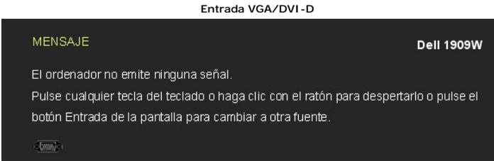
Si se selecciona la entrada VGA o DVI-D y no se conecta ni el cable VGA ni el DVI-D, aparecerá un cuadro de diálogo flotante como el siguiente.
