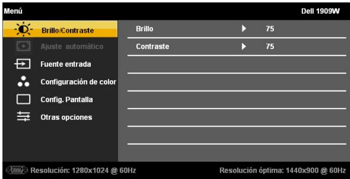
**NOTA:** La función de AJUSTE AUTOMÁTICO sólo estará disponible si utiliza el conector analógico (VGA).
