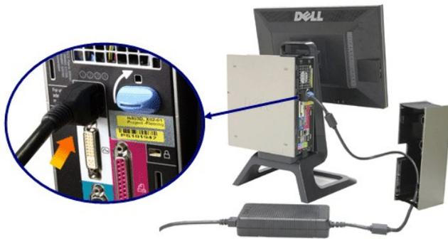
6. Conecte los cables USB de teclado y ratón al equipo, como se muestra en la imagen.
