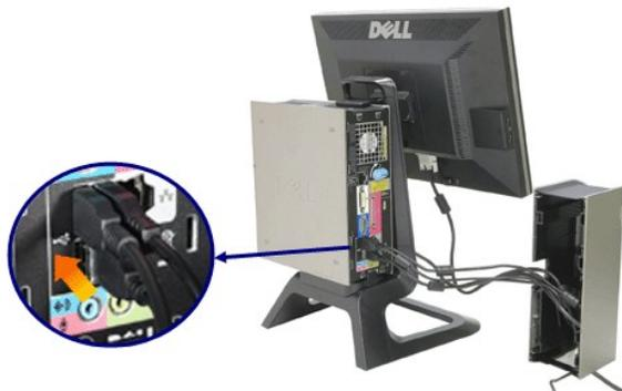
7. Conecte los cables de alimentación a una toma de suministro eléctrico. Instale la cubierta de cable.
