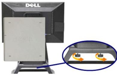
3. Conecte el cable DVI al equipo. Pase el cable DVI como se muestra en la imagen.
